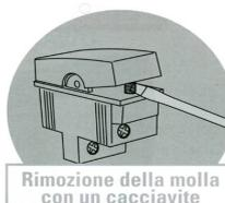
Rimozione della molla con un cacciavite
