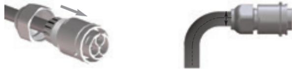
Avvitare il dado al corpo in modo da bloccare il cavo e stringere la guarnizione. Il dado va girato con una chiave (coppia di serraggio 2.5Nm) tenendo ben fermo il corpo. Il raggio di curvatura del cavo deve essere almeno 4 volte il valore del diametro del cavo.
