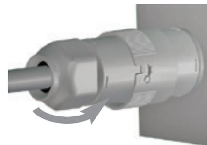
Ruotare completamente la ghiera in modo che i fermi posti sul corpo del connettore entrino perfettamente nelle aperture poste sulla ghiera
